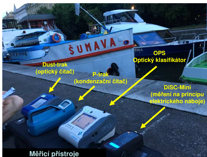
Obr. 4: Rozmístění měřicích přístrojů v oblasti PK Smíchov
