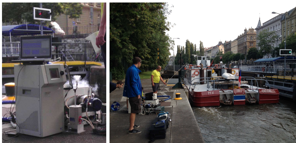
Obr. 8: Měřicí aparatura – klasifikátor částic a FTIR spektrometr (vlevo) a detail měření emisí projíždějící lodě (vpravo).
