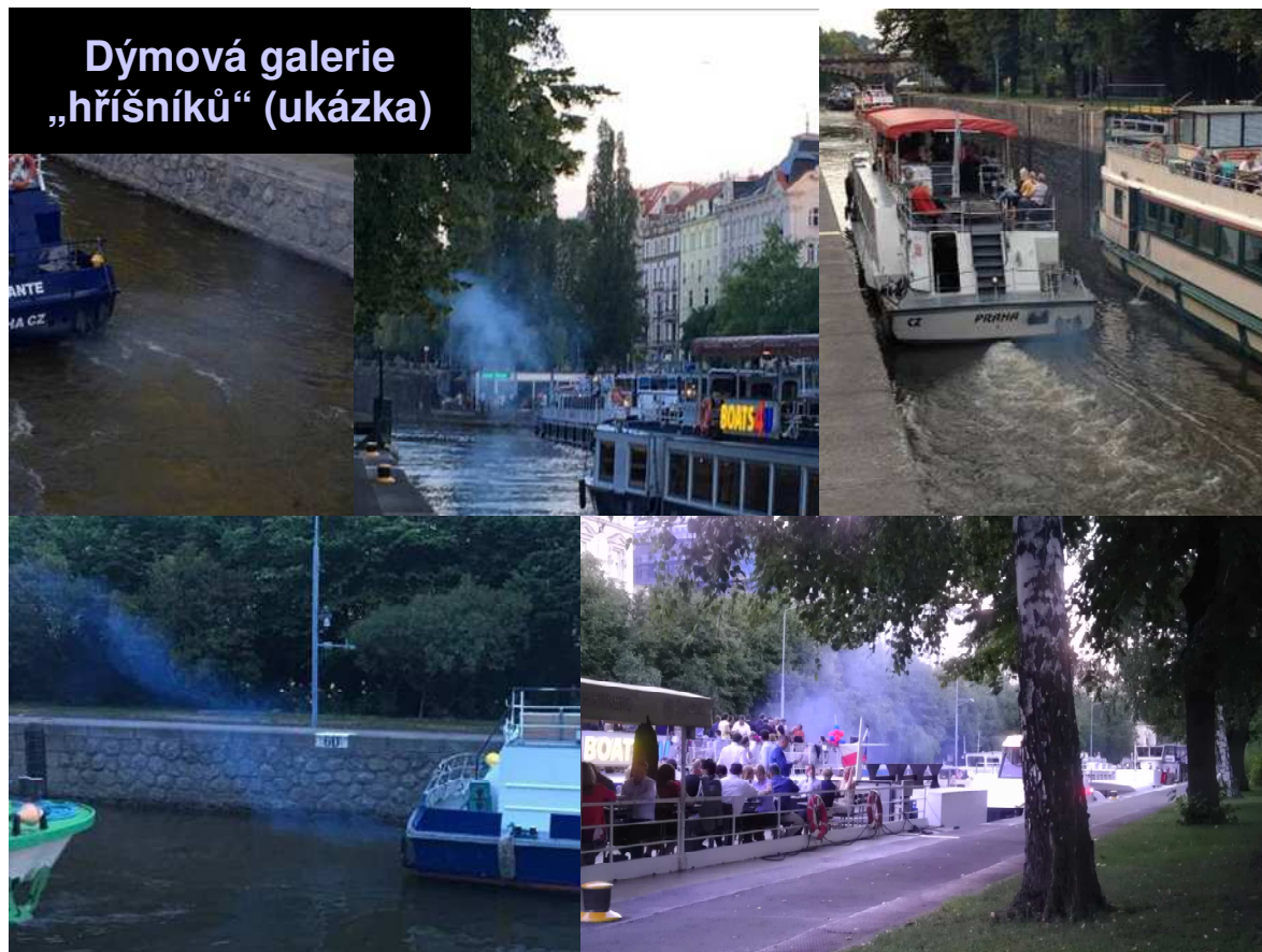
Obr. 12: Viditelný kouř zpravidla vypovídá o špatném technickém stavu motoru. Při vyšších zatíženích bývá kouř černý, při spalování oleje, nižších zatíženích a studených startech bývá modrý až šedý.
